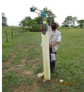
Sistema de riego por aspersión fija con cañón.
